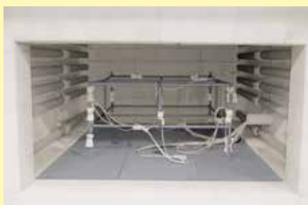
淬火炉内的测量结构
