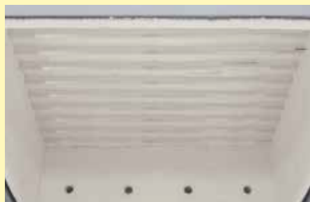
В верхней стенке плотно расположены нагревательные элементы, защищенные трубами из кварцевого стекла
