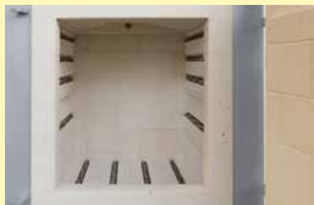
Обогрев с трех сторон при помощи нагревательных элементов, безопасно расположенных в желобках
