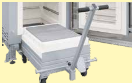
Эргономичный процесс загрузки с одной из трех сторон на выбор
