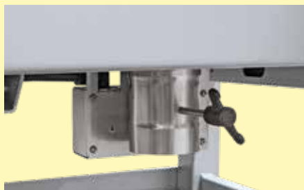
Полуавтоматический клапан приточного воздуха для досушки в камерных печах объемом до 300 литров
