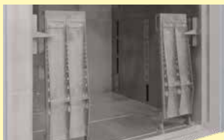
Rampes d'entrée pour les fours à isolation au sol pour les processus qui nécessitent une bonne homogénéité de la température
