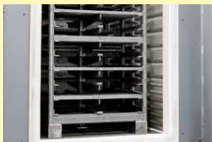
Châssis de chargement pour four chambre N 2200
