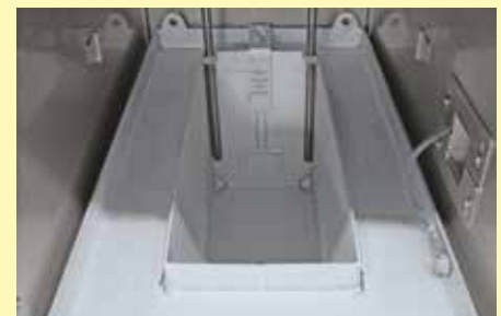
Creuset de bain de sel en acier CrNi de haute qualité
