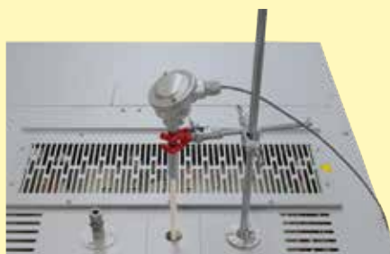
Passage des thermocouples dans la voûte avec pied
