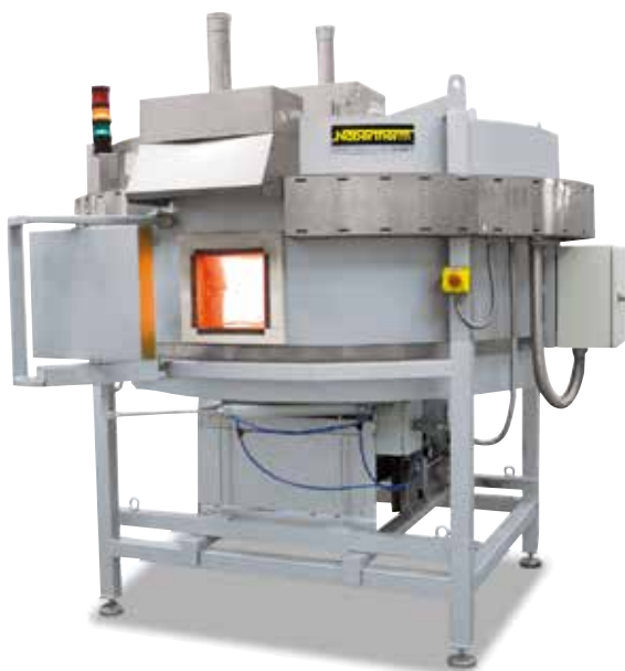
Four à sole rotative pour le préchauffage
