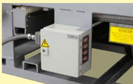
Raccord pour thermocouples de charge avec branchement à fiche
