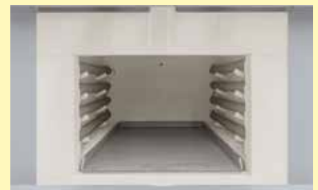
Four chambre avec une grande profondeur et résistances électriques sur trois côtés
