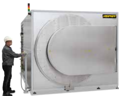
Four moufle étanche à paroi chaude NRA 3300/06 avec ouverture de porte automatique pour l'intégration dans une installation de trempe et de revenu entièrement automatique
