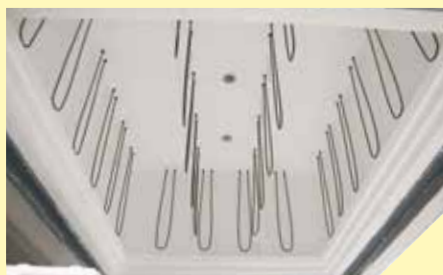
Chauffage de tous côtés et entre la pile pour l'optimisation de l'homogénéité dans la répartition des températures
