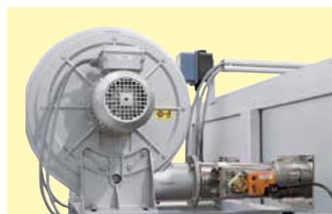
Ventilateur de refroidissement pour accélérer le refroidissement
