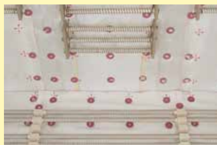
Couverture en tissu pour le tapis de fibres (et les côtés) pour réduire les poussières de fibres
