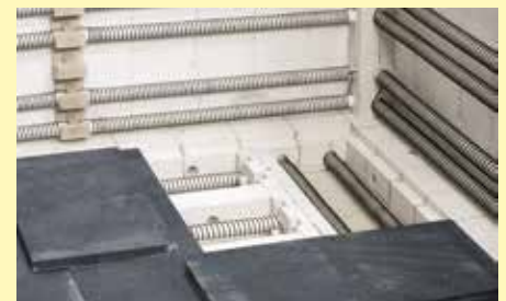
Chauffage de la sole recouvert de plaques SiC pour enfournement plan
