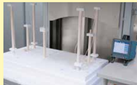
Dispositif d'analyse de la répartition de la température dans un four haute température à sole élévatrice
