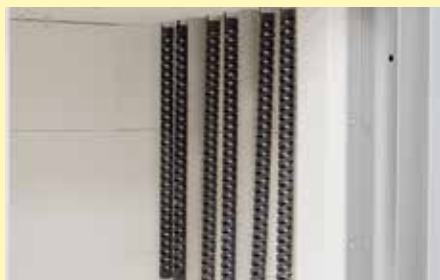
Barres SiC montées à la verticale et, en option, tubes d'arrivée d'air perforés pour système de déliantage dans un four haute température
