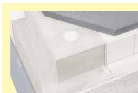
Traversées pour les thermocouples (Ø 40 mm) dans les angles avant de la sole mobile
