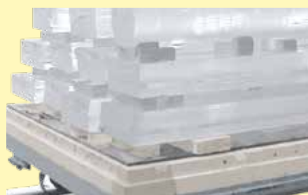
Four à sole mobile en fonctionnement pour le recuit de barres de quartz
