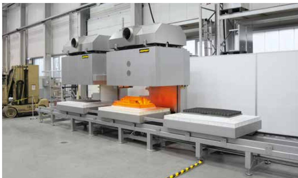
Impianto di bonifica automatico costituito da un forno a campana mobile e due campane per il raffreddamento forzato ad aria (seconda campana di raffreddamento a destra, non rappresentata) con sistema di tavoli intercambiabili.
