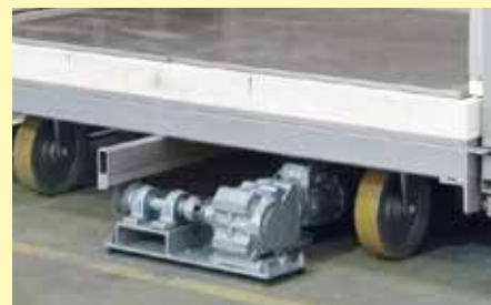
Carrello su ruote di alluminio senza spostamento delle rotaie e con azionamento a cremagliera
