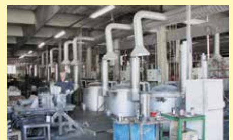
Brucciato a recupero su forno di fusione in alluminio 16 x TBR 110/12 e 2 x TBR 180/12
