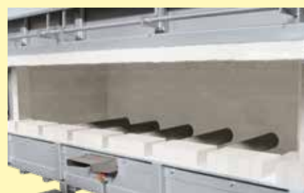
Riscaldamento indiretto a gas con tubi radianti
