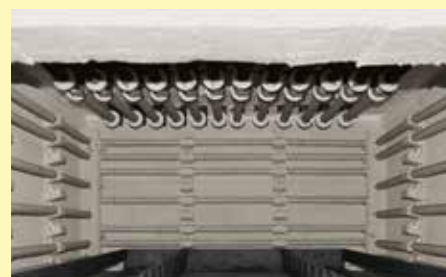
Camera del forno con riscaldamento del coperchio come dotazione aggiuntiva in caso di utilizzo del forno come forno di preriscaldamento per fogli di lamiera
