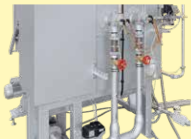
Sezione gas con due bruciatori nella parete posteriore del forno
