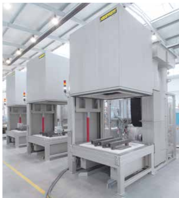
Impianto di produzione composto da 3 forni a campana HAS 1560/95S con struttura a tenuta, per il funzionamento in azoto e scambiatore di calore aria/gas per abbreviare i tempi di raffreddamento
