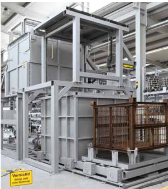
Impianto totalmente automatico con forno a caduta e gru di scarico (variante B)
