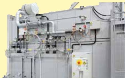
Sistema con bruciatore del forno a gas a suola mobile a convezione forzata WB 4000/85 AS
