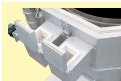
Regolazione automatica delle valvole di presa e scarico aria
