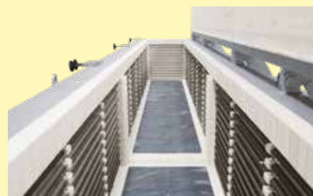
Camera del forno S 5120/GS con supporto che accoglie la piastra isolante per dividere a metà la camera del forno
