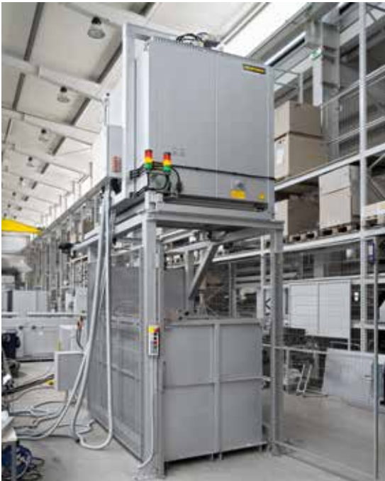
Impianto con forno a caduta con bagno di raffreddamento fisso (variante A)
