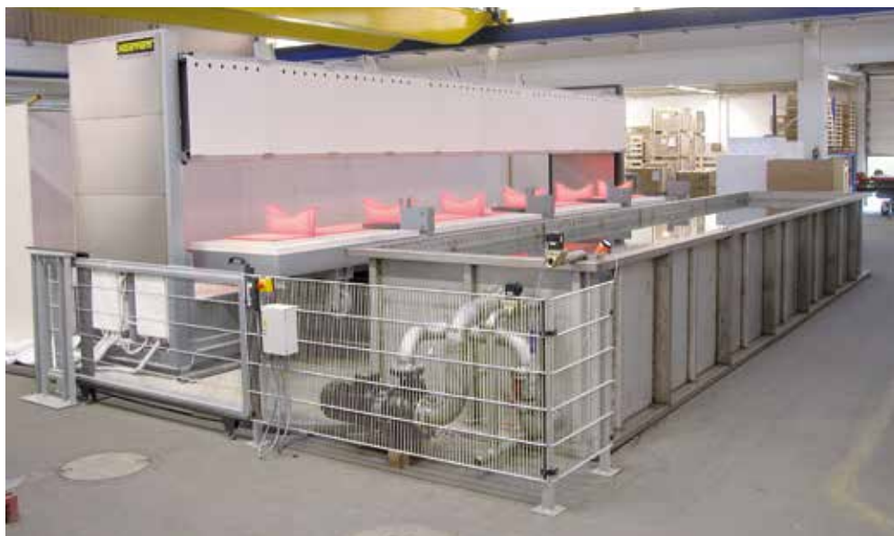
Impianto di bonifica con forni a campana mobile H 4263/12S e bagno ad acqua
