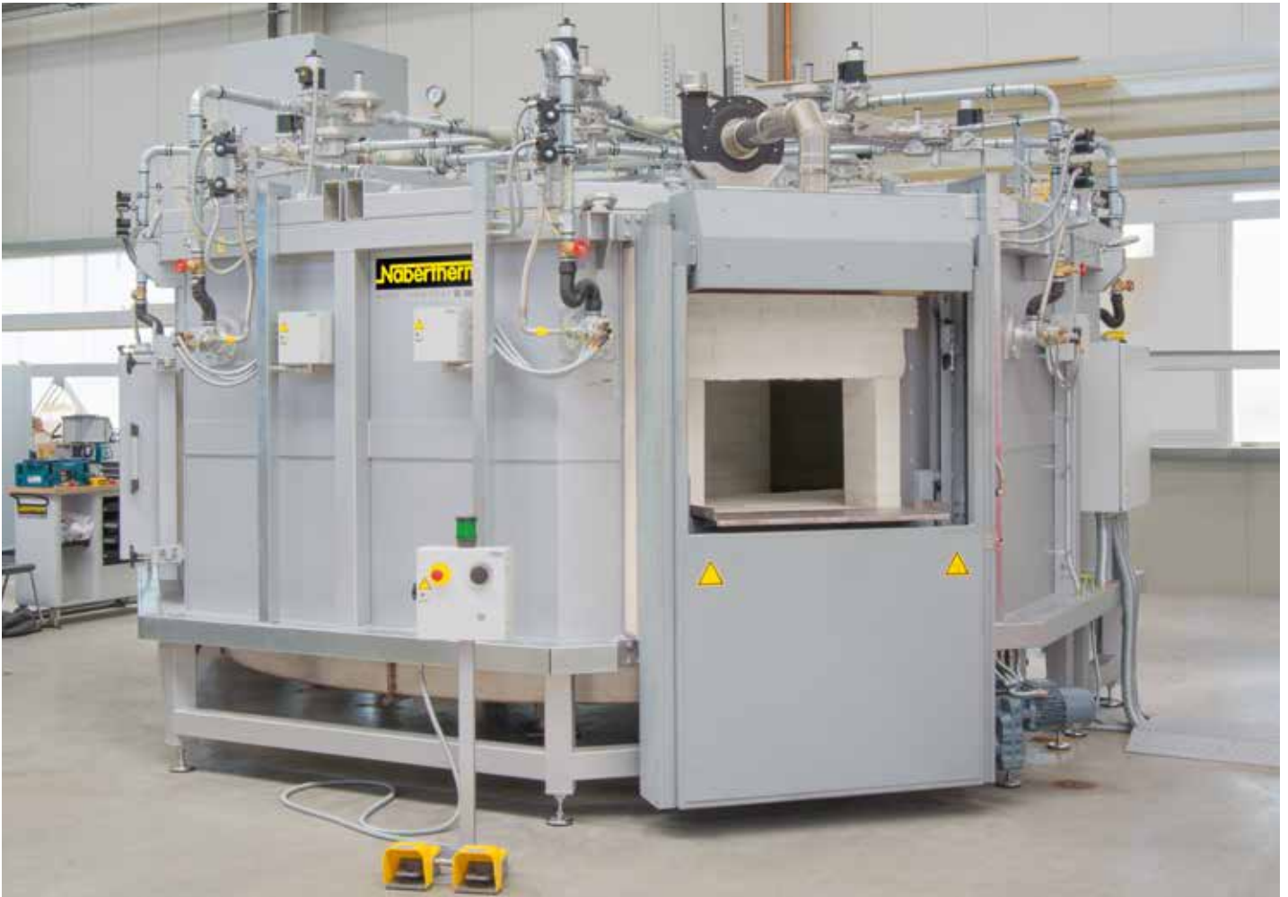
Forno a suola rotante a gas con Tmax 1100 °C per il preriscaldamento degli stampi
