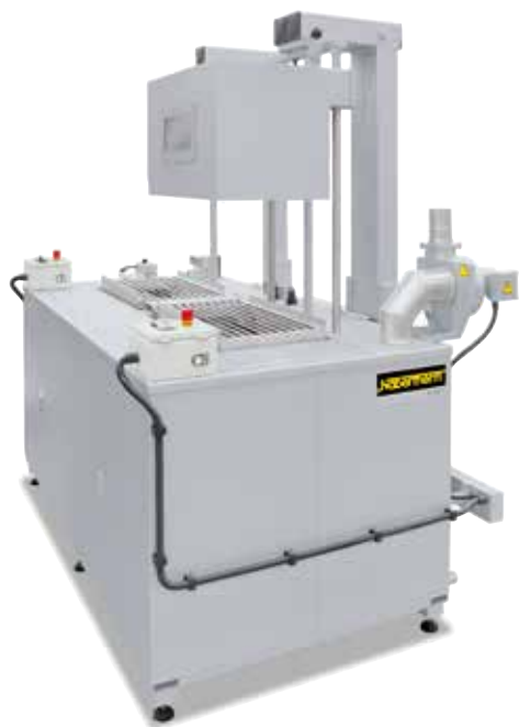
Bagno combinato di pulizia e raffreddamento a olio con tavolo ribassabile, calotta protettiva, separatore d'olio e aspirazione
