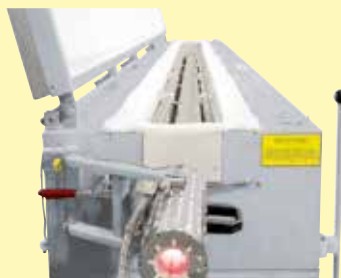
Forno continuo per ricottura filo sulla base di un forno tubolare con lunghezza di 6 metri
