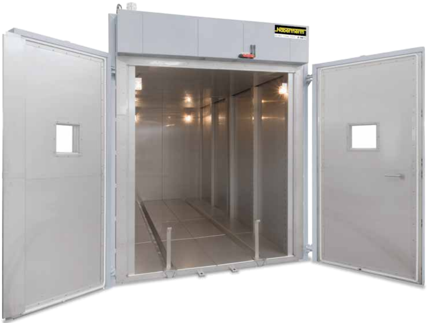
Essiccatore a camera KTR 22500/S con illuminazione interna e binari guida con tappi di isolamento per un'ottimale uniformità della temperatura
