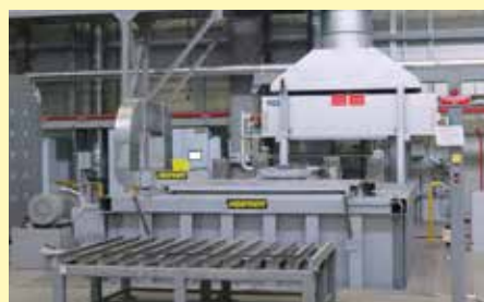
Bagno di raffreddamento a olio OAB 67000 con scambiatore di calore con una capacità di 67.000 litri di olio
