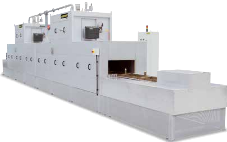
Forno continuo D 700/10000/300/45S con trasportatore a catena per 950 °C, riscaldamento a gas
