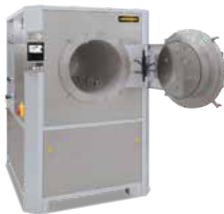
Forno a storte a pareti calde NR 80/11 per il trattamento di distensione di componenti metallici dopo la stampa 3D in atmosfera controllata o sotto vuoto
