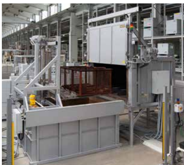
Impianto di bonifica orizzontale costituito da forno a camera a convezione, manipolatore a due assi e bagno di raffreddamento ad acqua
