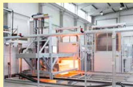
Impianto di bonifica completamente automatico per acciaio
