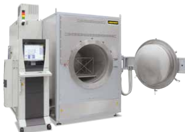
罐式炉NR 300/08用于高真空条件下的处理
