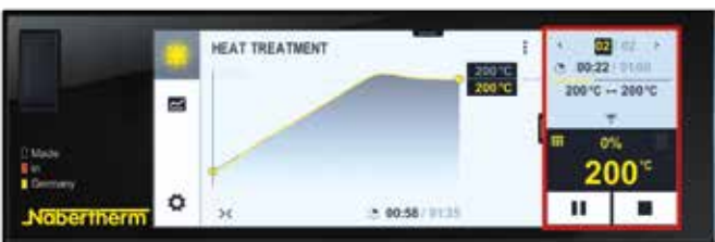
工艺信息的详细概览，包括设定值、实际值和切换功能
