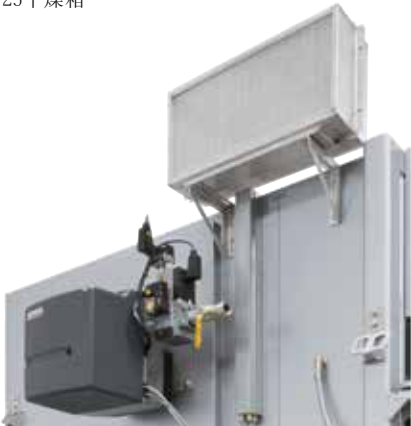
干燥箱上的直接气体加热
