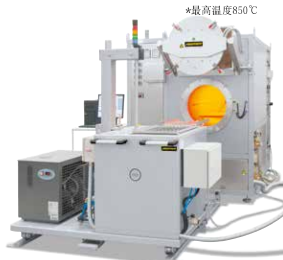
半自动调质设备，带NR 50/11型罐式炉和在一个轨道系统上的淬火水池
