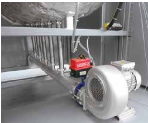
NRA 400/03型热壁罐式炉的鼓风机冷却
