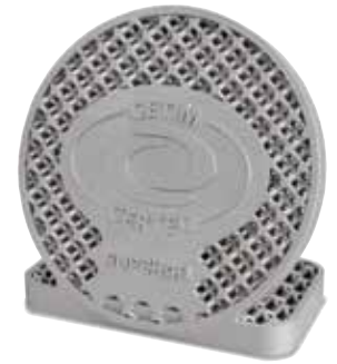
被打印的铝制部件，在N250/85 HA型窑炉中经过热处理（在SUPCHAD平台上的制造商CETIMCERTEC）
