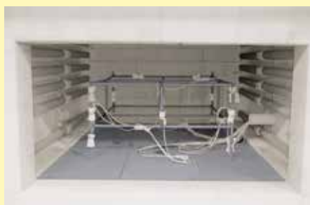
退火炉内的测量装置
