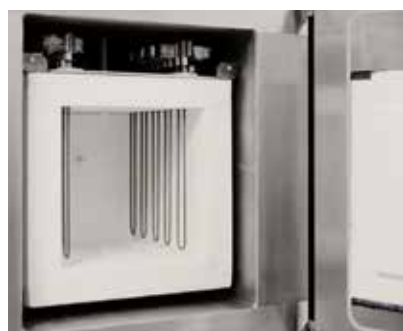
二硅化钼加热器和纤维保温层
