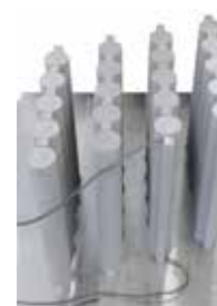
用NR 50/11型窑炉在氩气气氛中进行热处理后的钛拉伸棒
