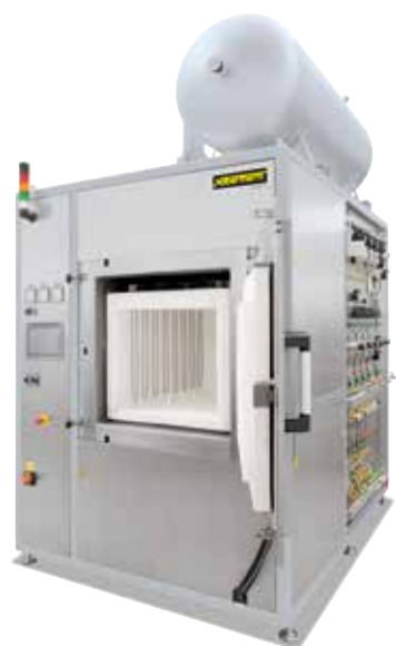
VHT 100/15-KE H 2 型罐式炉带有纤维保温层和扩展包，用于氢气环境下的操作，1400℃
