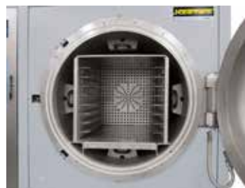
带有内部加热装置的炉罐
