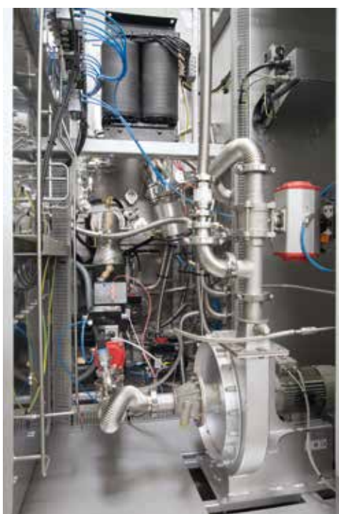
VHT 8/16-M0型冷壁罐式炉的气体快速冷却
