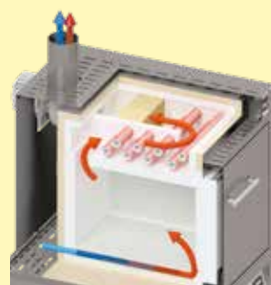
L 24/11 B0型灰化炉中的空气导向示意图
