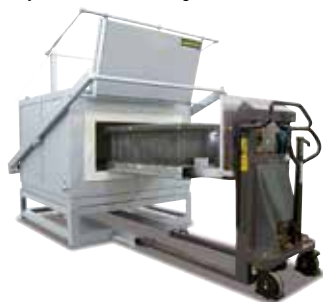
Vagoneta de carga con caja de recocido para la inyección de gas y horno
