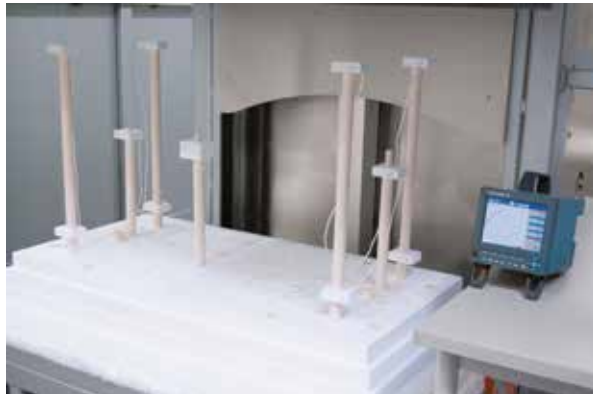
Estructura de medición en un horno de altas temperaturas
