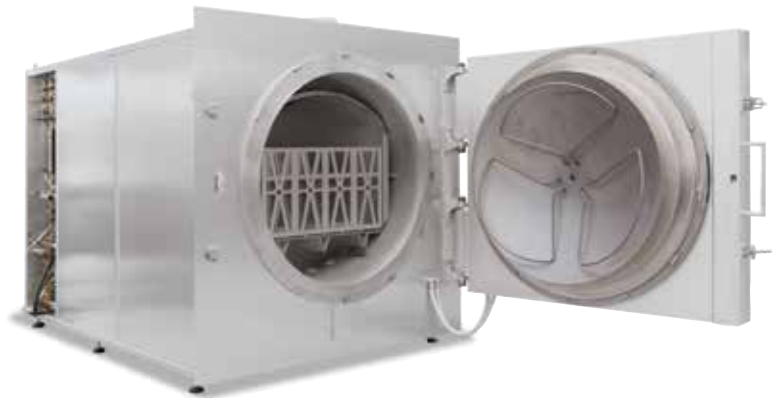
Horno de retorta de pared caliente con retorta NRA 1700/06 con carro de carga para la instalación en la sala gris, con puerta de carga en la sala limpia para el tratamiento térmico de vidrio en atmósfera de gas protector
