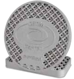
Componente impreso de aluminio, sometido a tratamiento térmico en el modelo N 250/85 HA (fabricante CETIM CERTEC en plataforma SUPCHAD)
