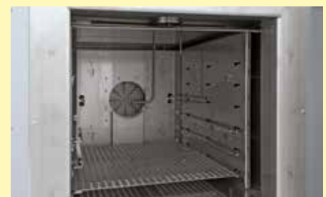
Innenraum mit Einlegeblech, Thermoelementen und Drucküberwachung
