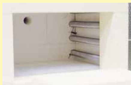
Ofeninnenraum mit hochwertiger Feuerleichtsteinisolierung
