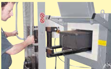
Arbeiten mit Begasungskasten für Schutzgasatmosphäre mit Hilfe eines Chargierwagens
