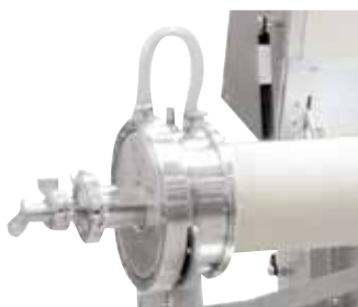
Wassergekühlter Vakuumflansch (Begasungspaket 2)
