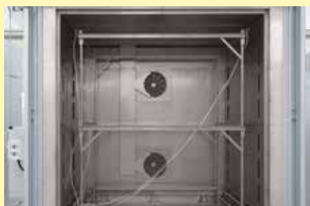
Steckbares Messgestell für Umluft-Kammerofen N 7920/45 HAS
