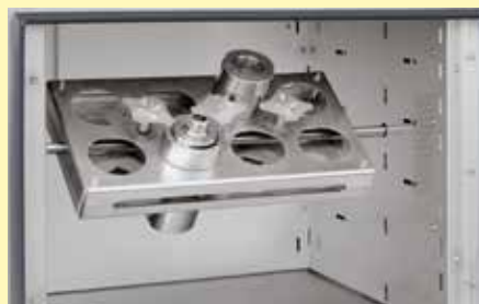
Elektrische Drehvorrichtung (hier mit kundenspezifischer Plattform für PARR-Behälter)
