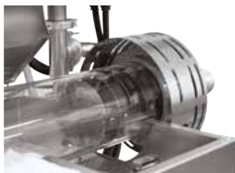
Flansch mit Strahlschutzeinsatz (Begasungspaket 15)
