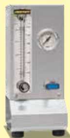
Begasungssystem für nicht brennbares Prozessgas
