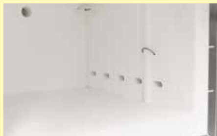
Ofeninnenraum mit Lufteinlassöffnungen für 6-fachen Luftwechsel je Minute
