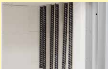
Vertikal aufgehängte SiC-Stäbe und optionale Lufteinblasrohre des Entbinderspaketes in einem Hochtemperaturofen
