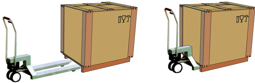
Εικ. 17: Το ανυψωτικό όχημα έχει τοποθετηθεί ολόκληρο κάτω από το πλαίσιο μεταφοράς
