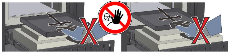
Εικ. 36: Παράδειγμα: Αποφυγή ζημίας της μόνωσης της θύρας (παρόμοια με την εικόνα)
