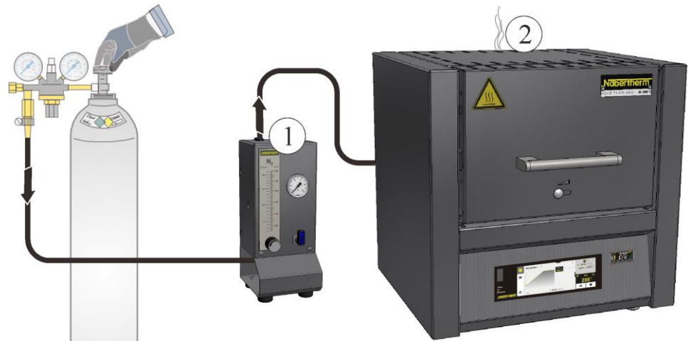
50 pav.: prijungimas prie dujų tiekimo sistemos (panašu į paveikslėlio vaizdą)
