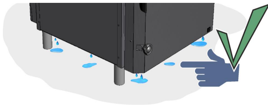
Изображение 67: Натрупване на кондензат по време на първите изпичания (изображението е илюстративно)
