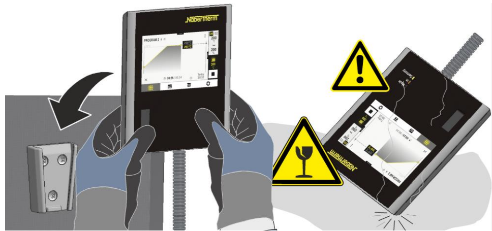
Изображение 55: Поставяне на контролера в намиращия се на пещта държач (изображението е илюстративно)
