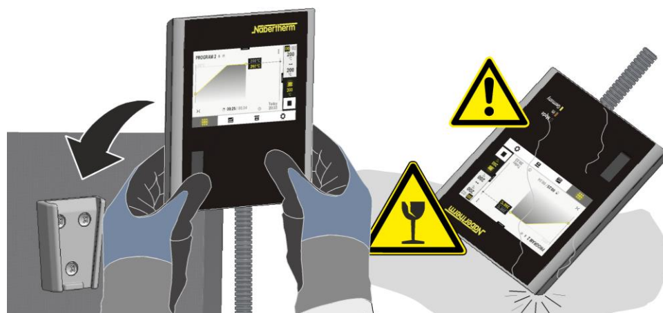
Rys. 55: Mocowanie sterownika w uchwycie przy piecu (wygląd zbliżony)
