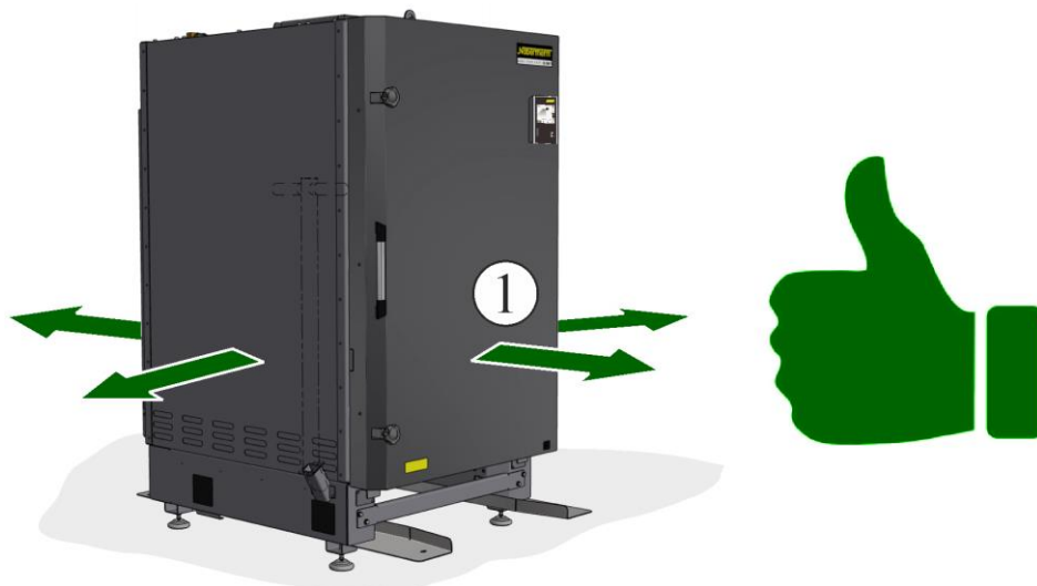
Rys. 28: Osadzanie i pozycjonowanie pieca (ilustracja pogładowa)
