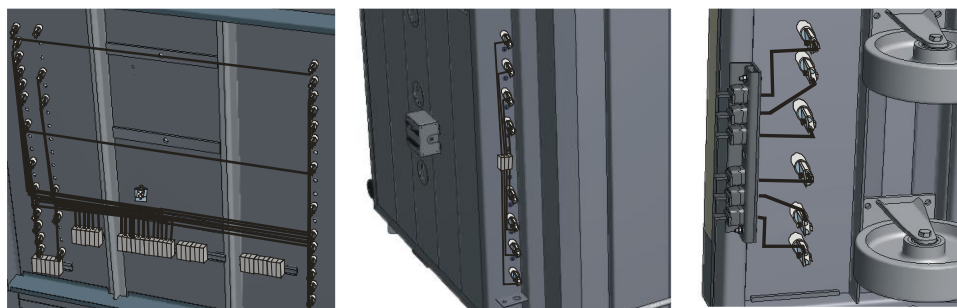
Rys. 95: Przykład: Rozmieszczenie elementów grzewczych (ilustracja pogładowa)
