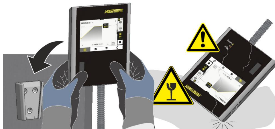
Fig. 71: Colocar o controlador no suporte que se encontra no forno (semelhante à figura)
