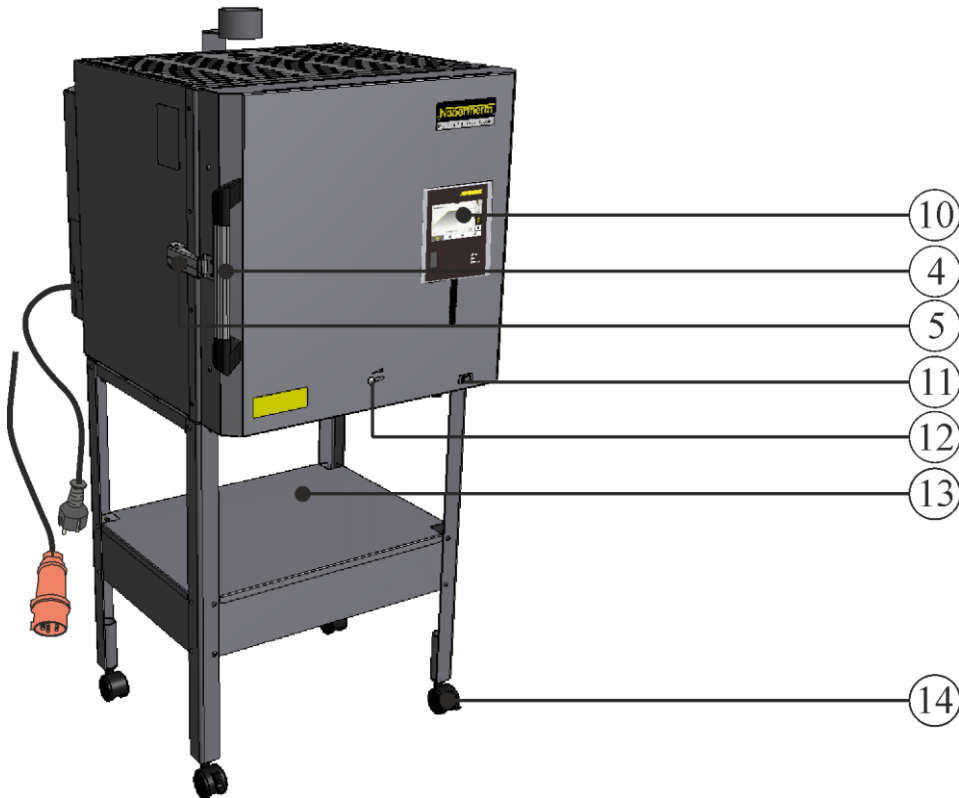
Fig. 1: Exemplo: Forno de câmara N 40 E (modelo de mesa) com armação inferior e rolos de transporte enquanto acessório
