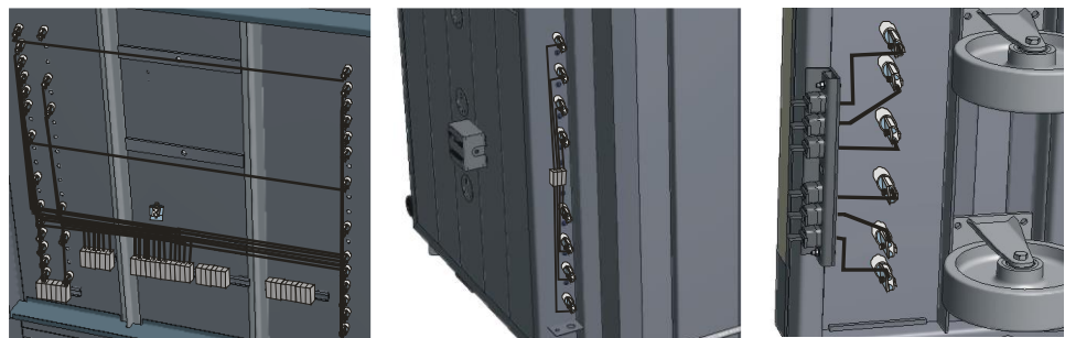
Fig. 95: Exemplo: Disposição dos elementos de aquecimento (ilustração exemplificativa)
