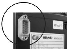
Il Controller presenta sul retro dell'alloggiamento un'interfaccia digitale **RS 422** che consente l'allacciamento a un normale PC. Usando un **software di regolazione** adeguato si possono comodamente gestire e controllare esternamente tutte le caratteristiche del programma.
