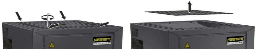
Obr. 44: Demontáž krytu – model LHT 01/17 D (přibližný obrázek)
