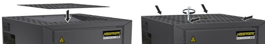
Obr. 51: Montáž krytu – model LHT 01/17 D (přibližný obrázek)
