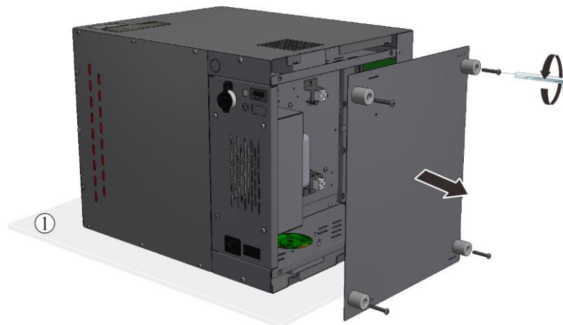
Obr. 54: Demontáž podlahové desky – model LHT 01/17 D (přibližný obrázek)
