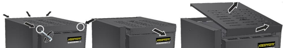
Obr. 45: Demontáž krytu – model LHT 03/17 D (přibližný obrázek)
