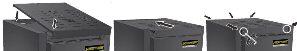
Obr. 52: Montáž krytu – model LHT 03/17 D (přibližný obrázek)
