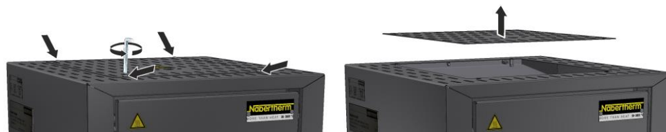
Obr. 17: Demontáž krytu – model LHT 01/17 D (přibližný obrázek)
