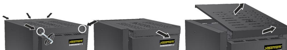
Obr. 37: Demontáž krytu – model LHT 03/17 D (přibližný obrázek)
