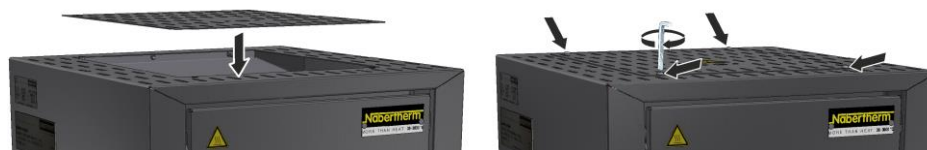
Obr. 39: Montáž krytu – model LHT 01/17 D (přibližný obrázek)
