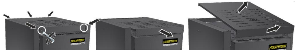
Kuva 45: Katteen poisottaminen mallissa LHT 03/17 D (kuva viitteellinen)
