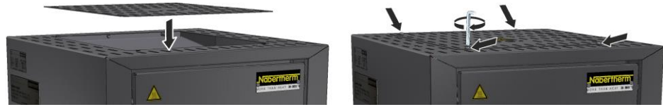
Kuva 19: Katteen asentaminen mallissa LHT 01/17 D (kuva viitteellinen)
