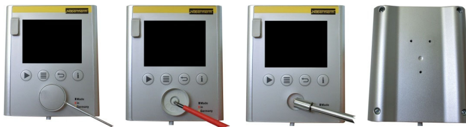
Joonis 12. Juhtpaneeli trükkplaadi demonteerimine – osa 1 (sarnane joonis)
