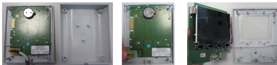
Joonis 13. Juhtpaneeli trükkplaadi demonteerimine – osa 2 (sarnane joonis)
