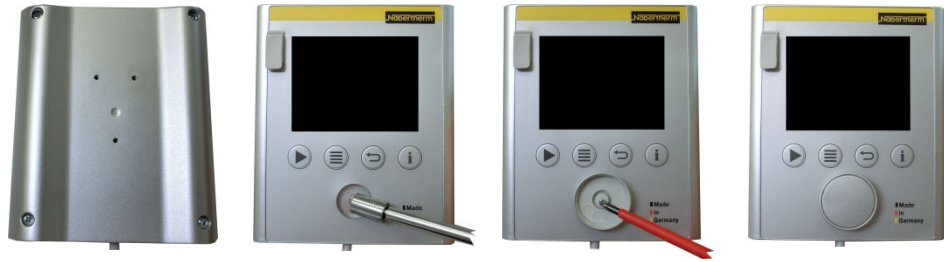
Joonis 16. Juhtpaneeli trükkplaadi paigaldamine – osa 3 (sarnane joonis)
