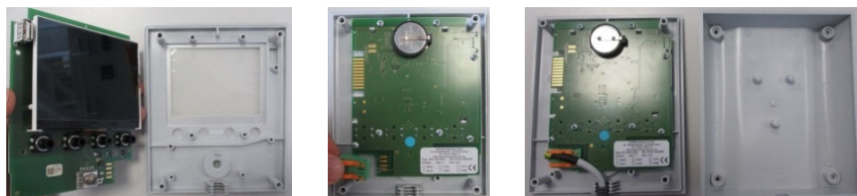
Joonis 15. Juhtpaneeli trükkplaadi paigaldamine – osa 2 (sarnane joonis)
