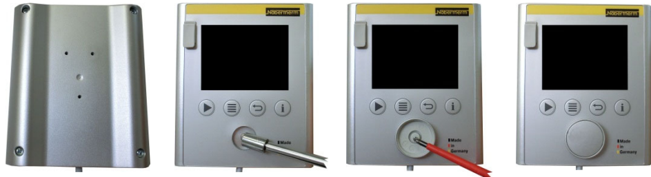
Εικ. 16: Εγκατάσταση της πλάκας του ελεγκτή - Μέρος 3 (παρόμοια με την εικόνα)
