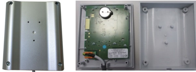
Εικ. 11: Αντικατάσταση ελεγκτή (παρόμοια με τη φωτογραφία)
