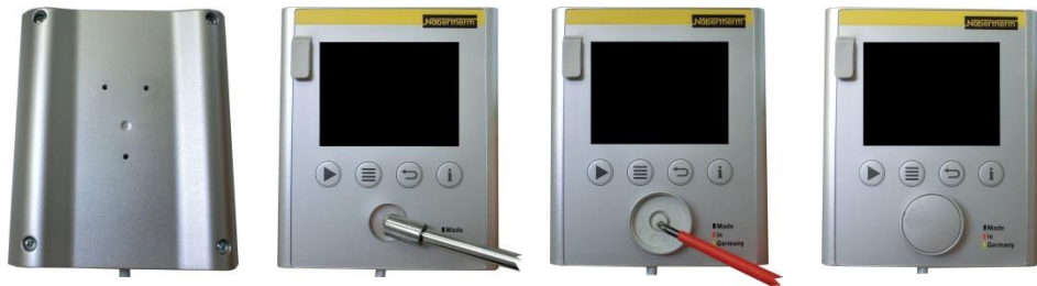
Fig. 16: Montaggio della scheda del controller – Parte 3 (illustrazione simile)
