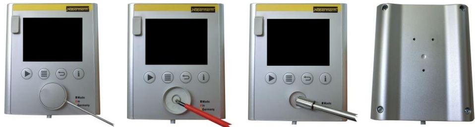
Fig. 12: Smontaggio della scheda del controller – Parte 1 (illustrazione simile)
