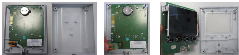
Fig. 13: Smontaggio della scheda del controller – Parte 2 (illustrazione simile)
