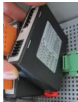
Fig. 19: Montaggio dei moduli regolatore (illustrazione simile)
