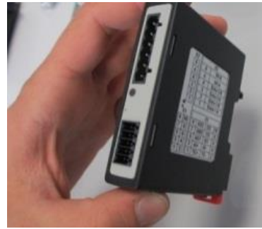
Fig. 18: Smontaggio dei moduli regolatore – Parte 2 (illustrazione simile)
