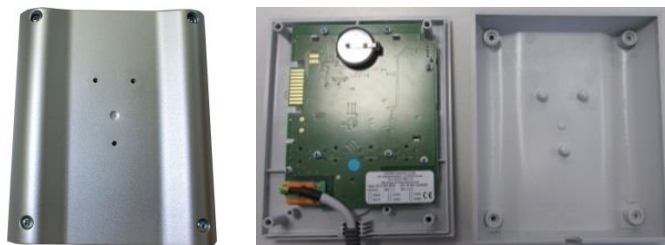
Fig. 11: Înlocuirea unui controler (Figură similară)
