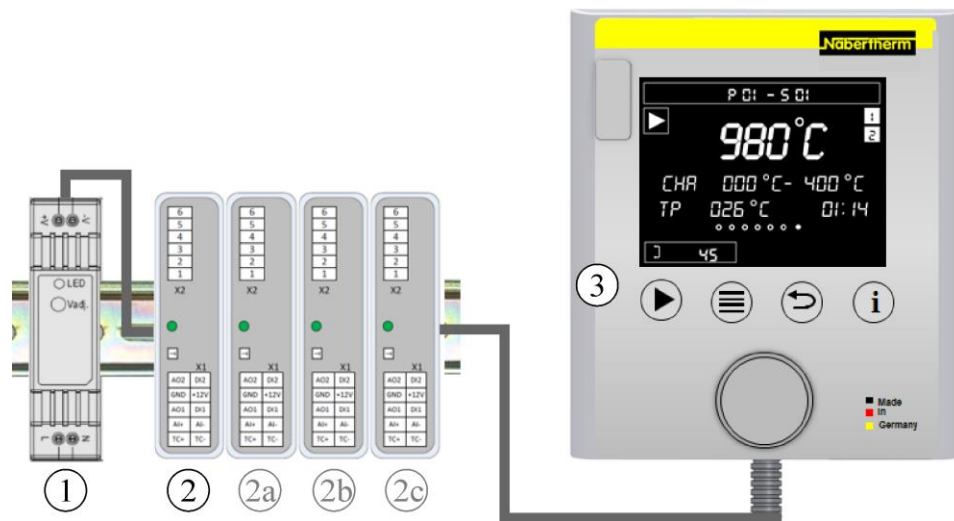
Fig. 1: Dispunerea modulelor individuale ale controlerului (Figură similară)
