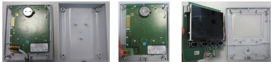
Fig. 13: Demontarea plăcii de circuit a controlerului – Partea 2 (Figură similară)
