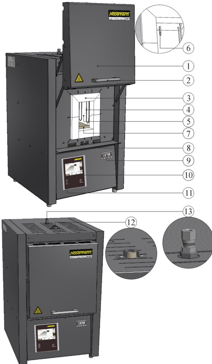
Bild 1: Högtemperatursugn (bilden visar specialutförande med temperaturvals begränsare) (liknar den på bilden)
