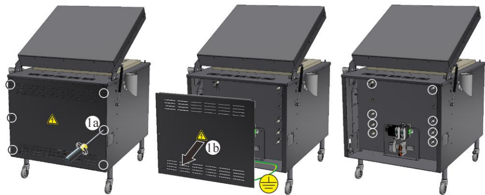
Afb. 75: afdekking van de schakelinstallatie aan de achterzijde van de oven demonteren (afbeelding vergelijkbaar)
