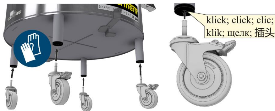
Afb. 15: montage van de transportwieltjes (afbeelding vergelijkbaar)
