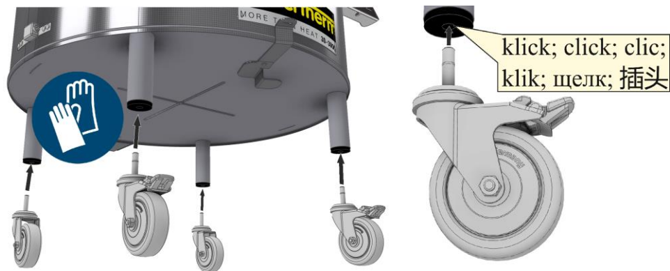
Abb. 15: Montage der Transportrollen (Abbildung ähnlich)
