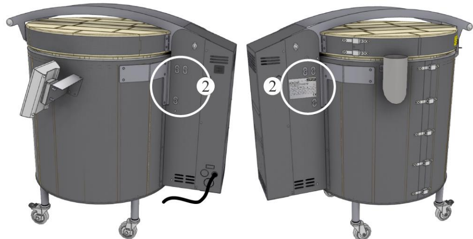
Befindliche Schrauben auf beiden Seiten der Schaltanlagenabdeckung zum Einstellen des Deckels
